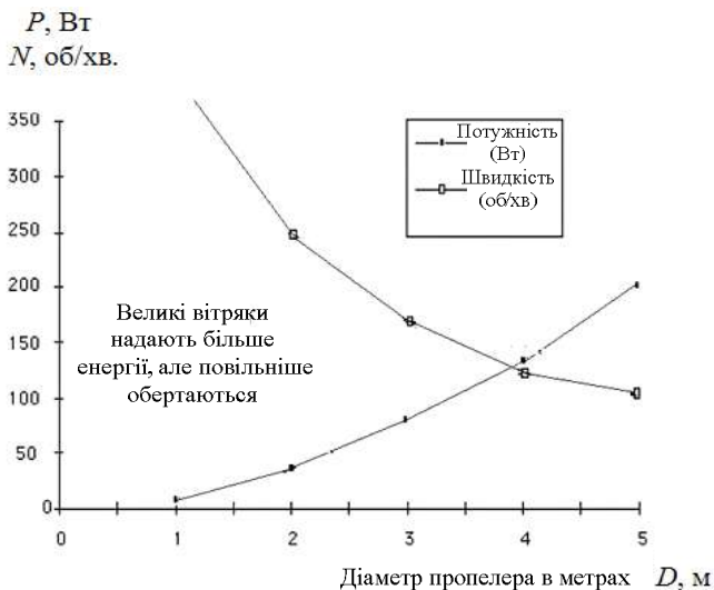
Рис. 2.45. Вибір діаметра ротора в залежності від необхідної потужності
