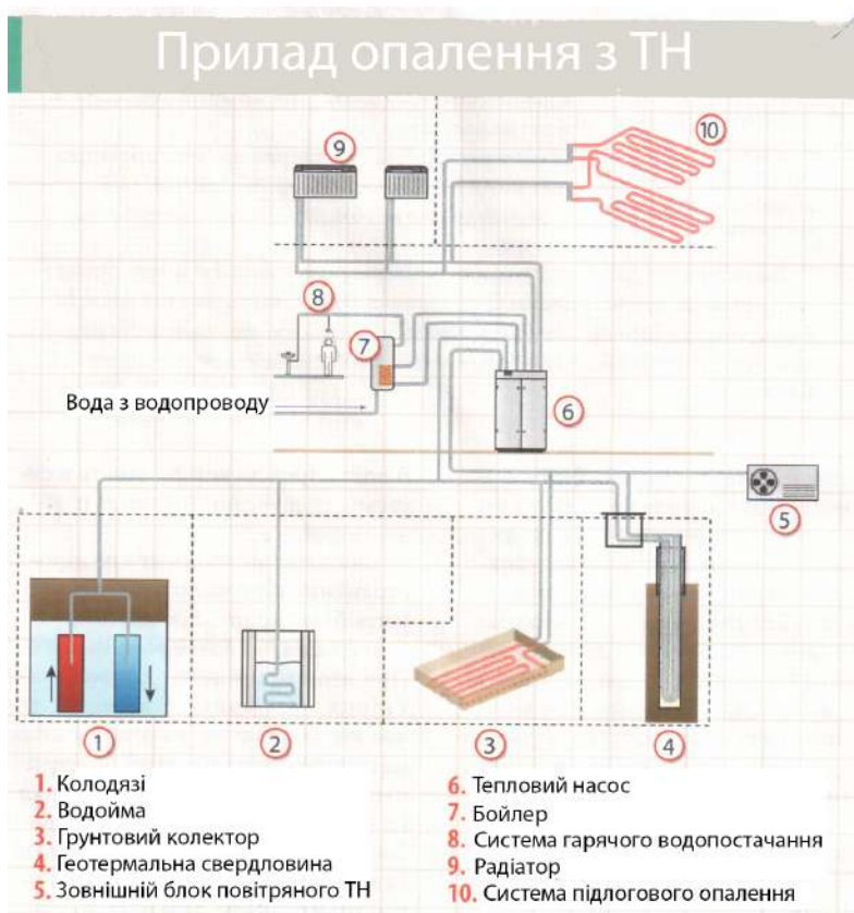
Рис. 4.21. Загальна схема опалення з тепловим насосом
