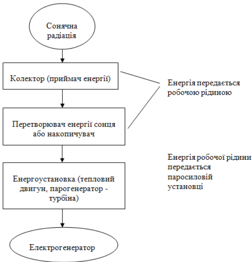
Рис. 1.8. Схема одержання електричної енергії сонячною теплоелектростанцією
