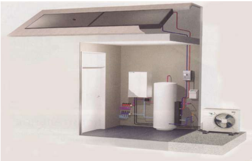
Рис. 4.23. Оптимальне розміщення обладнання теплового насоса
