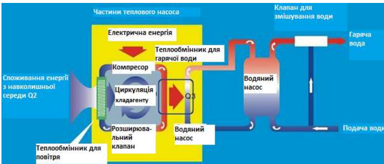
Рис. 4.13. Складові частини теплового насоса водного типу
