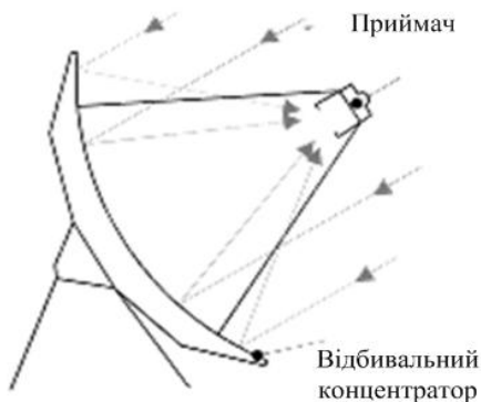
Рис. 3.5. Структурна схема СЕС тарілкового типу
