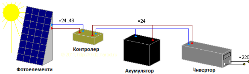
Рис. 3.47. Схема системи енергозабезпечення на сонячних батареях
